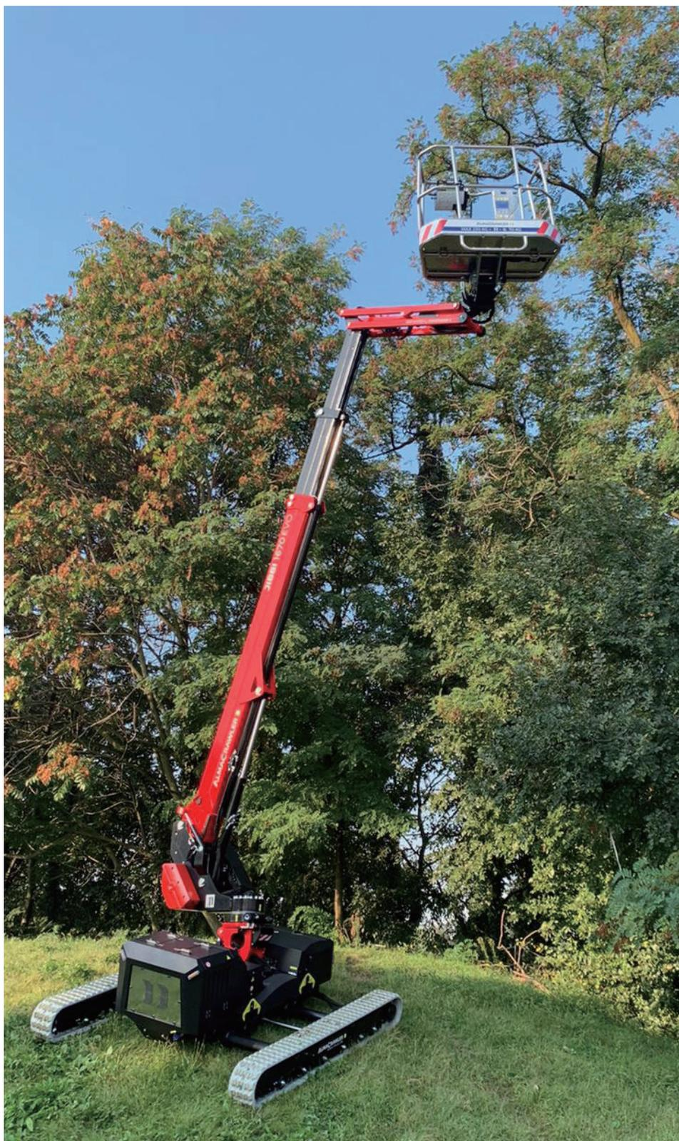
最大作業床14.0mの傾斜地用屈伸クローラーブームリフトです。前後左右どの方向でも傾斜に対応できる為、舗装されていない現場の細かい傾斜や、従来のクローラーブームリフトでは対応できない現場でもJIBBI1670なら安全に作業が可能です。作業効率も大幅にUPする為、コスト削減にも貢献します。
