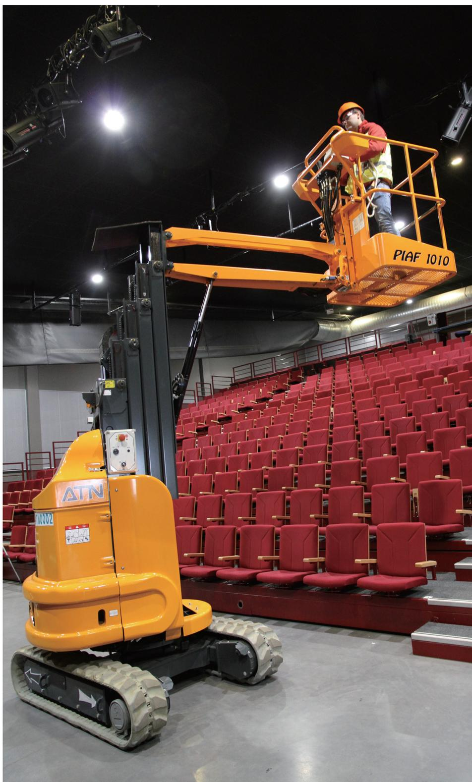
国内初、クローラー式電動マストブームリフト。床高8.05m・全長2.74m・重量2780kgとコンパクトかつ軽量のボディでこれまで届かなかったエリアへのアクセスを可能にします。足回りにクローラーを採用する事で小さな段差や凹凸を乗り越え、地盤の悪い現場でも作業が可能です。また設置面積が広がる為、耐荷重が気になる現場での使用にも適しています。クローラー特有のピボットターンで狭小地など、旋回スペースの確保が難しい現場でも活躍します。室内外問わずご使用頂けます。
