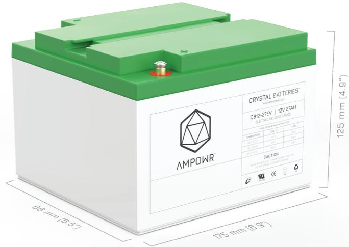
クリスタルバッテリーは、電解質をほぼ固体状態にすることで、従来のバッテリー問題を克服した独自の技術です。これにより、バッテリーをより深く放電でき、よりサイクル回数が増え、より長寿命となります。極端な温度にも耐えることができる特許取得済みのクリスタルテクノロジーは、独自の高度な配合で、従来の硫酸溶液に代わるものとして開発された新しいタイプの複合電解質を使用しています。
