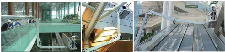
ダブルジブで作業したい場所までピンポイントにアクセスが可能です。またジブがマイナス方向に屈折する為、複雑な建築構造物のメンテナンスや補修工事に最適です。
