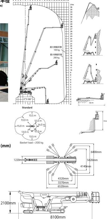
〈バスケット〉 幅794mm 横1404mm 高さ1323mm
