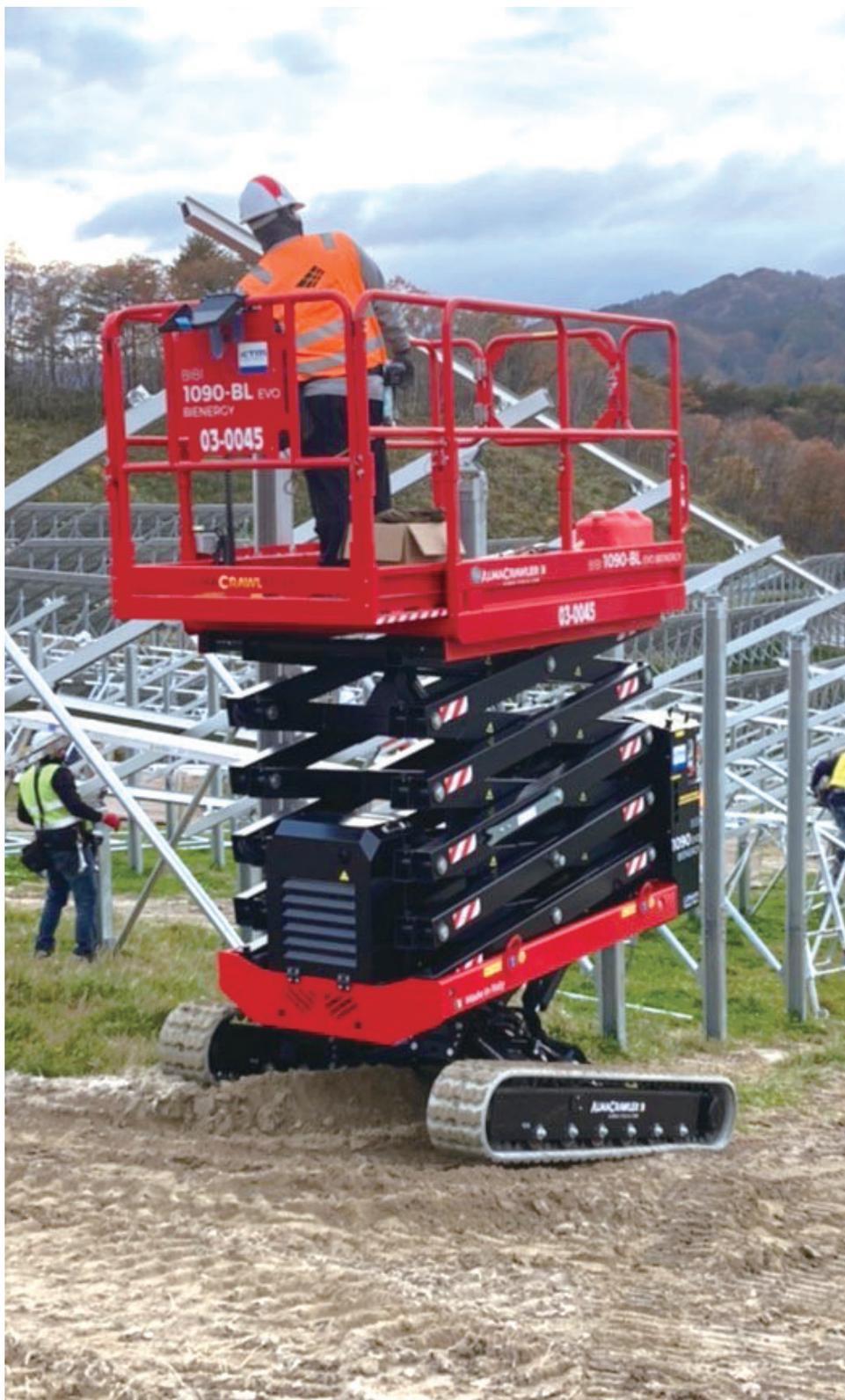
ALMACの不整地対応シザースリフトは、傾斜のある坂道や不整地・段差に対応するクローラタイプの高所作業車です。
