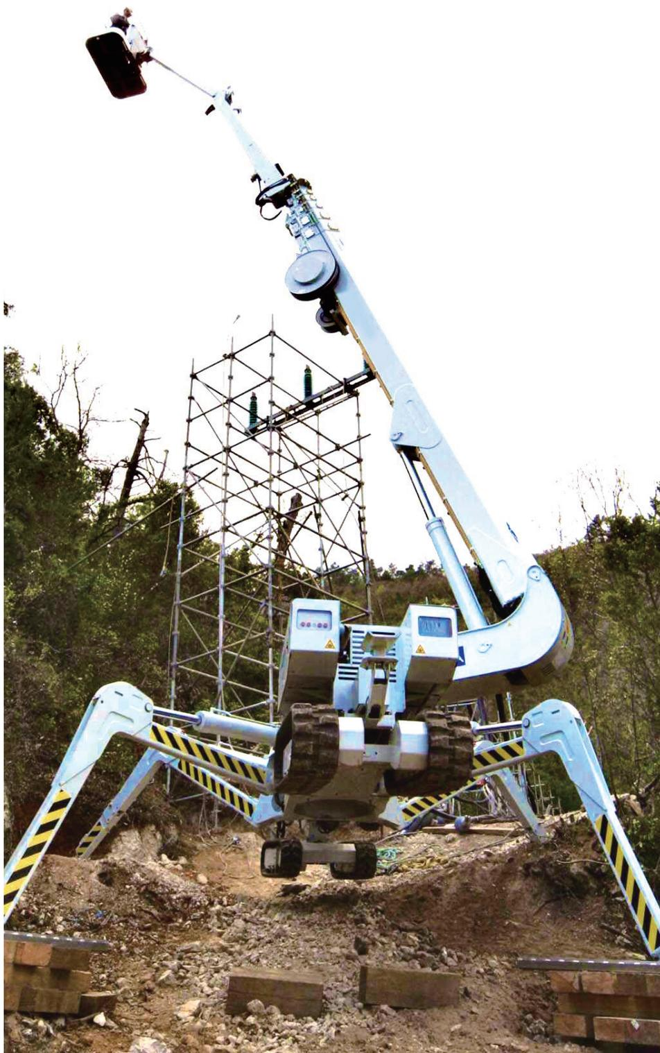
ダブルクローラーを搭載した、国内最大級のスパイダーブームリフト。床高35m、重量7350kg前後2箇所にもクローラーを搭載し、前部のクローラーが伸縮することで安定した斜面の乗り降りを実現しました。これにより傾斜に差しかかった際にも天秤になる事なく、不安定な場所でも安全な作業が行えるようになりました。また登坂能力30度とパワフルな走行性能により山間部などの急斜面も走破可能です。
