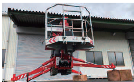
4 段差のある場所でもアウトリガーを張って作業可能
