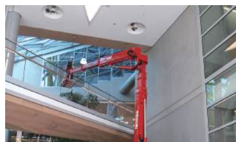
6 屈伸式で障害物を乗り越え、 作業エリアにアプローチ可能
